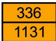
Il numero di identificazione del pericolo **KEMLER/ONU** è posto sul retro e sulle fiancate dei mezzi che trasportano sostanze pericolose; serve per identificare il tipo di pericolo e il tipo di materia trasportata. In caso di incidente, comunicando ai Vigili del Fuoco i numeri riportati sul pannello, si fornisce un valido aiuto per stabilire le metodologie degli interventi di soccorso.
