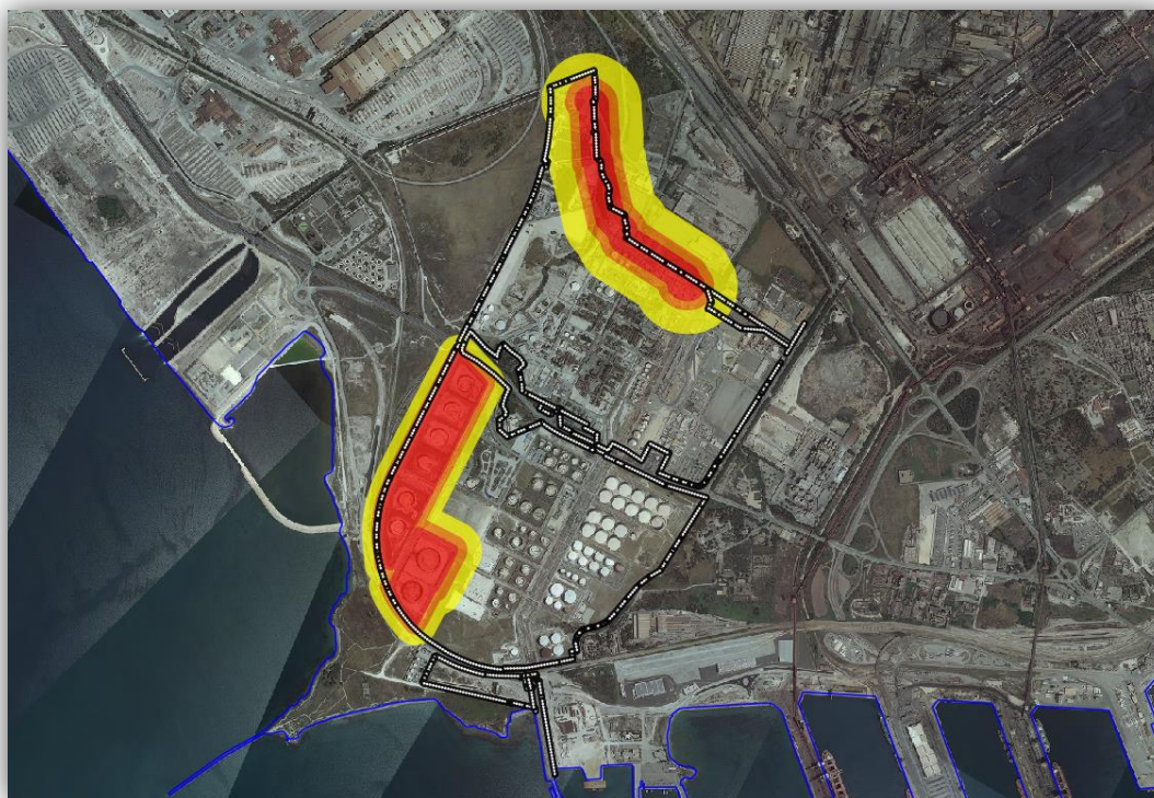
Figura 69. Rischio industriale. ENI S.p.A. Inviluppo delle aree di danno con effetti all'esterno dello stabilimento per irraggiamento dovuto a radiazione termica istantanea (Flash Fire).
