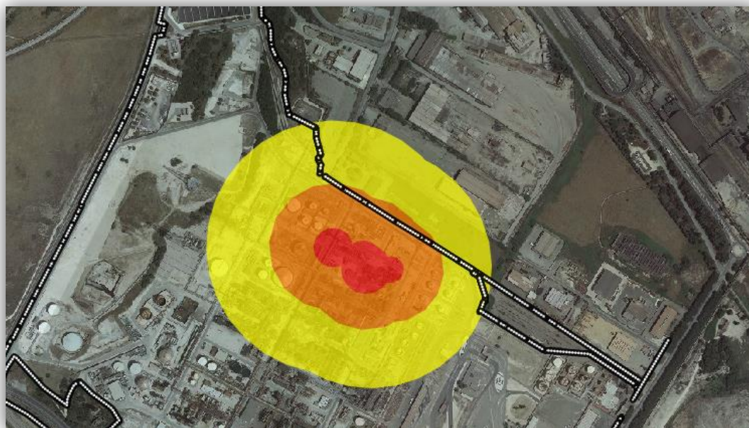
Figura 70. Rischio industriale. ENI S.p.A. Inviluppo delle aree di danno con effetti all'esterno dello stabilimento per dispersione tossica (idrogeno solforato).
